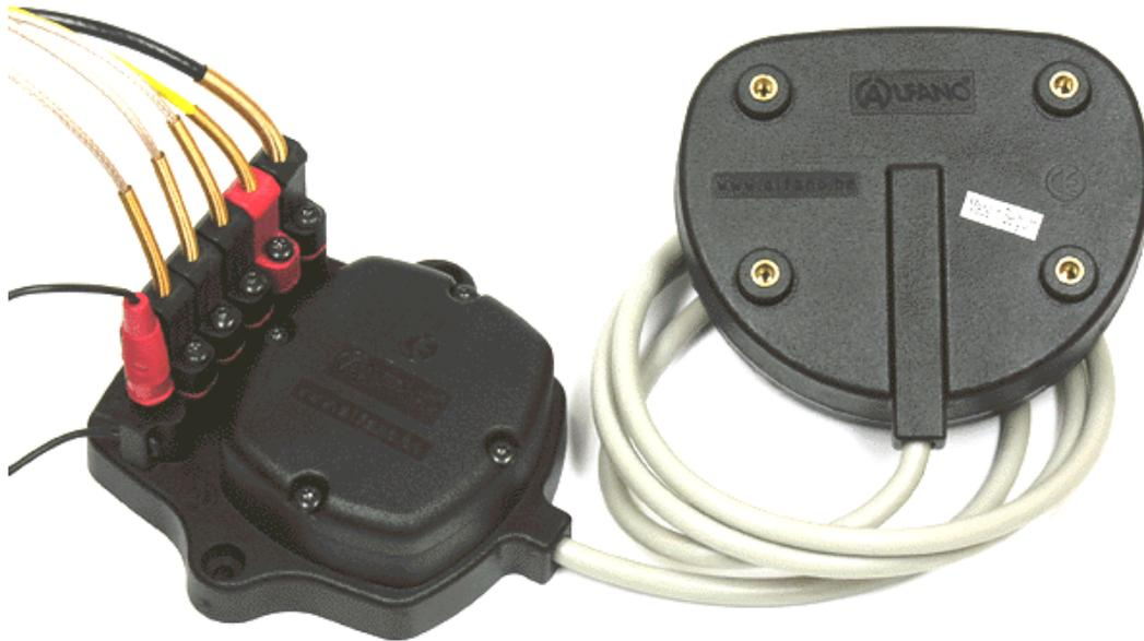
Der **AstrO Formula** & **AstrO Formula 4T** bestehen aus zwei Teilen: die Batterien und die Sensoren sind an einem anderen separaten Gehäuse befestigt. Diese Anordnung hat mehrere Vorteile. Einer dieser Vorteile ist, dass die Rückwand des Chronometers flach ist. Dadurch ist die Installation des Gerätes zum Beispiel auf einem Armaturenbrett möglich. Außerdem haben die Batterien des **AstrO Formula** & **AstrO Formula 4T** eine höhere Nutzungsdauer.
