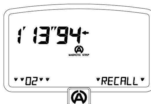
Um in das Menü zu gelangen, drücken sie kurz den rechten Knopf des Chronometers. Beim Start dieses Menüs positioniert sich das Chronometer auf die letzte aufgezeichnete Runde. Das Chronometer kann Ihnen folgende Werte automatisch für jede Runde anzeigen:
