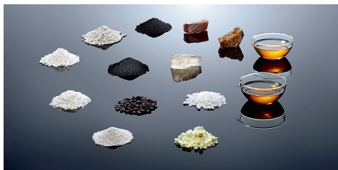
Die verschiedenen Inhaltsstoffe eines Reifens.
