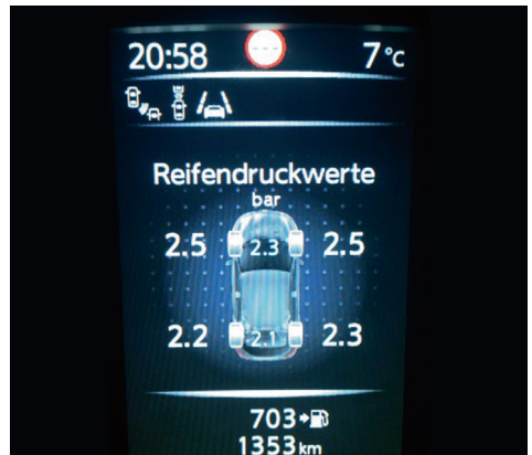
Beispielanzeige eines direkt messenden Systems.
