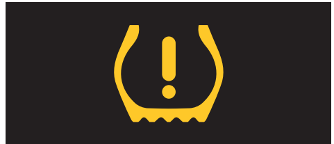
Beispielanzeige eines indirekt oder direkt messenden Systems.
